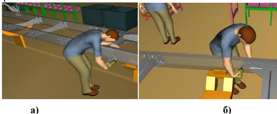
Рисунок 2. Проверка технологичности сборочной операции «Установка держателя заднего крыла»: а) закрепление детали с внешней стороны рамы), б) закрепление детали с внутренней стороны рамы.
