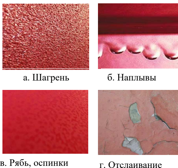
Рис. 1. Альбом дефектов окраски
