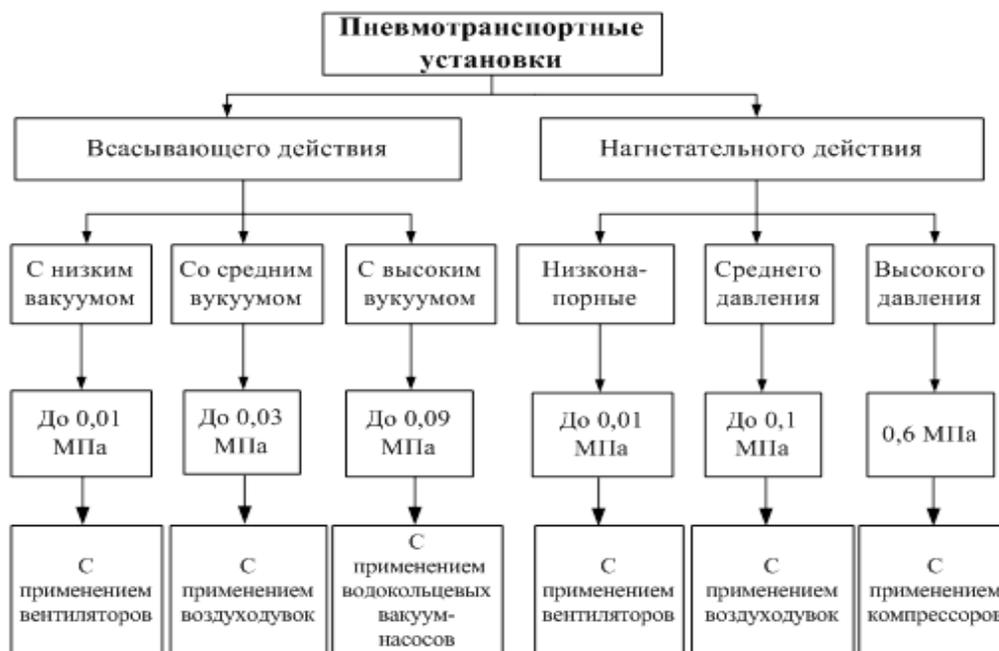
**Рис. 1. Схема классификации пневмотранспортных установок**
