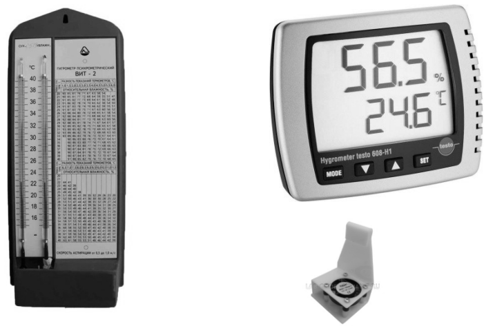
Рис. 1. Приборы для определения параметров окружающей среды а) гигрометр психометрический исп.ВИТ-2, б) Testo 608-H1
