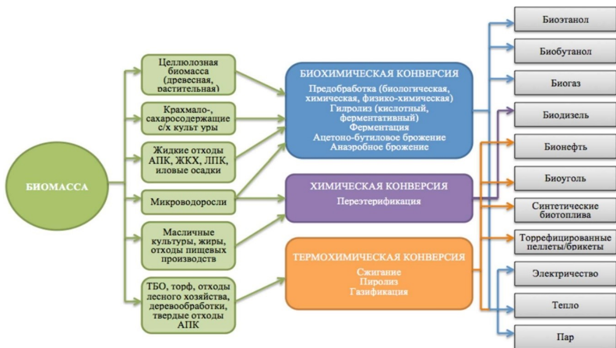
Рис. 3. Основные процессы трансформации биомассы в биоэнергетические ресурсы
