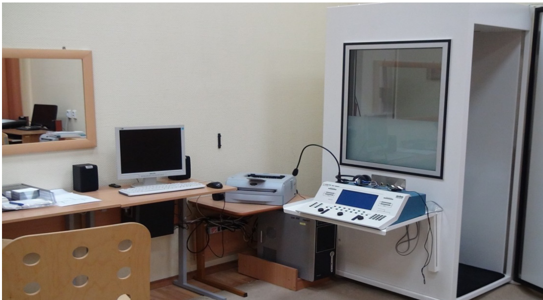
Рис. 2.2. Система измерений с заглушенной кабиной
