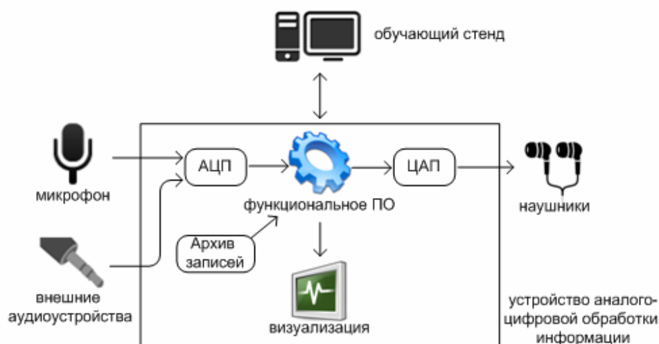
Рис. 2.15. Схема функционирования слухоречевого тренажера
